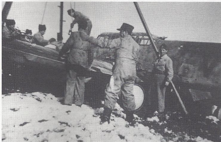
Schweizer Spezialisten demontieren die VQ+KL für den Abtransport nach Dübendorf. Die linke Tragfläche ist schon bereits vom Rumpf getrennt
