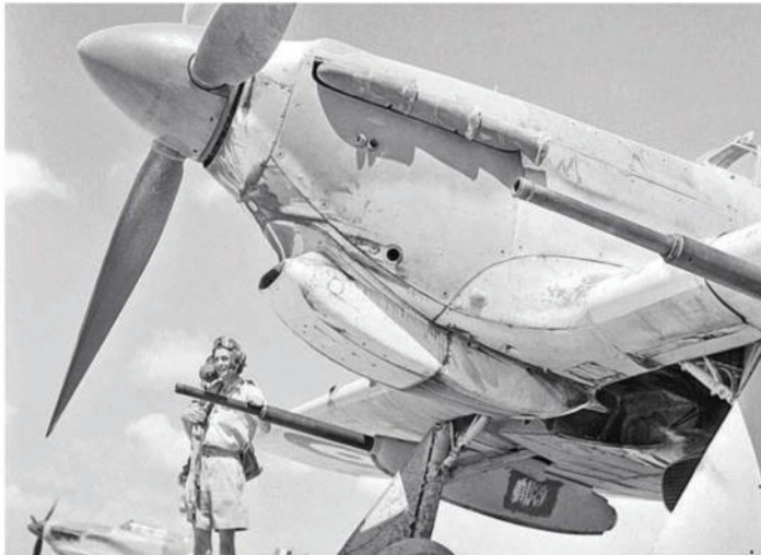
Hawker Hurricane Mk.IID mit 40-mm-Geschützen zur Panzerjagd
