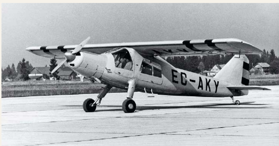
Der überarbeitete zweite Prototyp Do 25 P-2C mit Continental-Boxermotor und in die Flächen integrierten Kraftstoffbehältern
